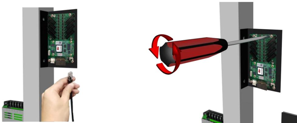
先将接收卡排线网线拆落，再将固定接收卡与接收卡支架间的螺丝拧下，即可拆卸接收卡
