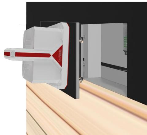
LED 魔法吸盘平行于 LED 模块，将吸盘贴合灯面，打开设备开关，按住吸附键，垂直向外拉出，取出时用另一只手拿住模组，再松开吸附键，谨防滑落。
