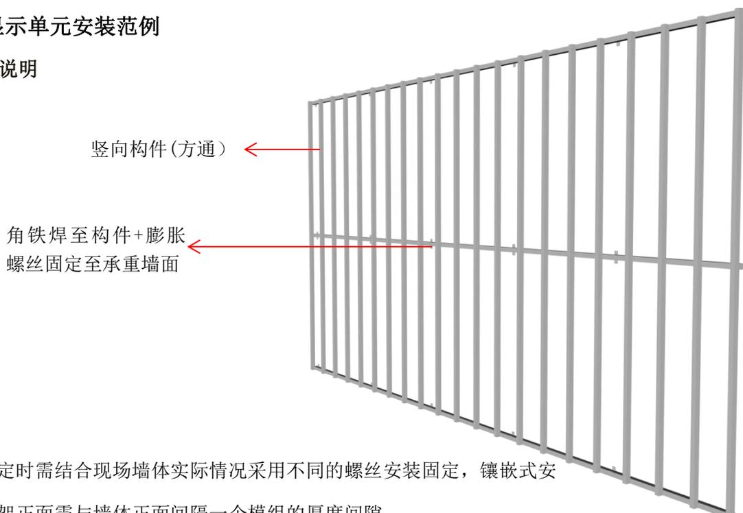
结构架固定时需结合现场墙体实际情况采用不同的螺丝安装固定，镶嵌式安
