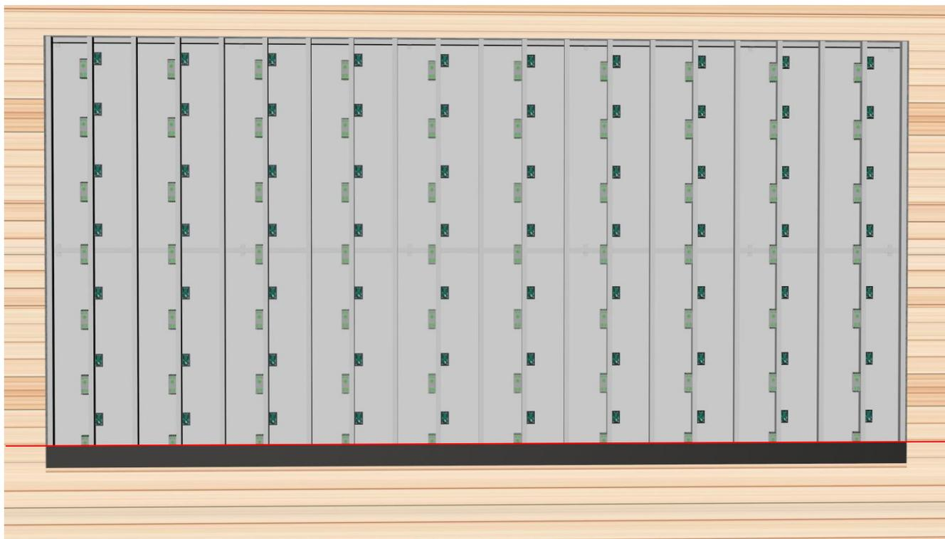
安装完第一排后再次用红外水平仪确认平整度，第一层必须要安装在同一水平面上，否则有误差安装在后面时误差会叠加变大从而会影响到安装。
