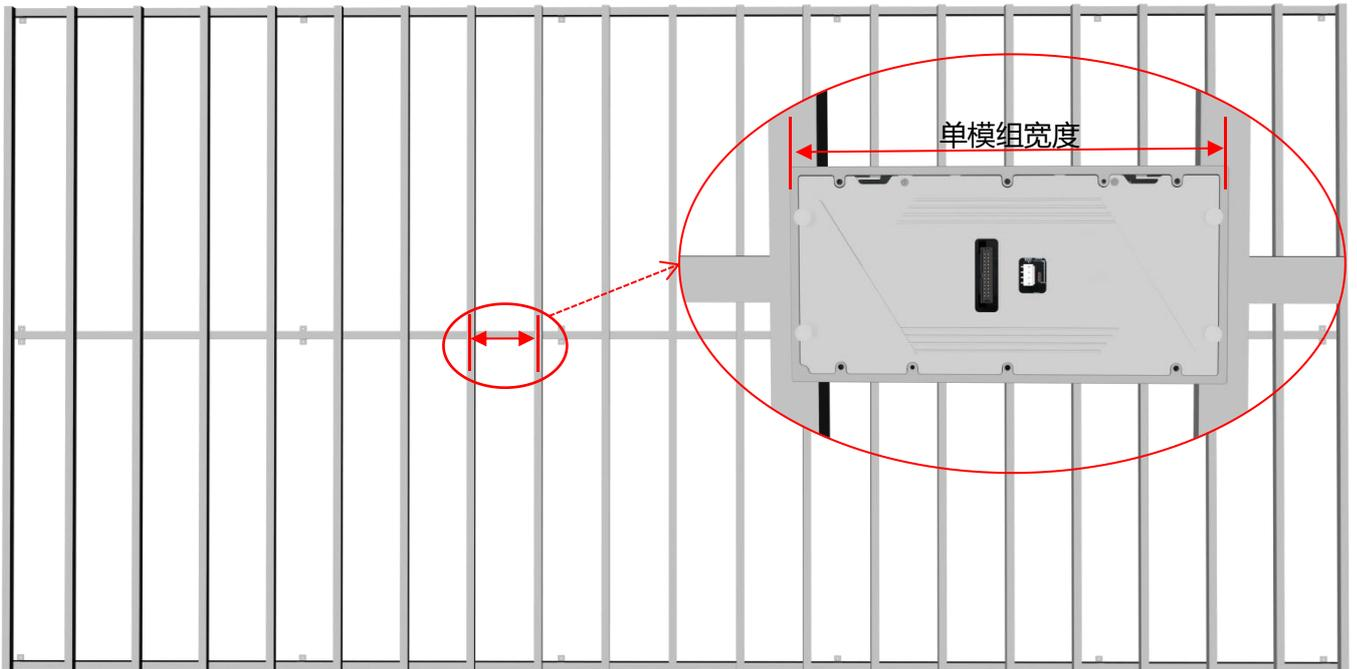
将结构架安装固定后确认结构方面都无问题后开始进行下一步操作准备安装电源/HUB 板，如下所示：
