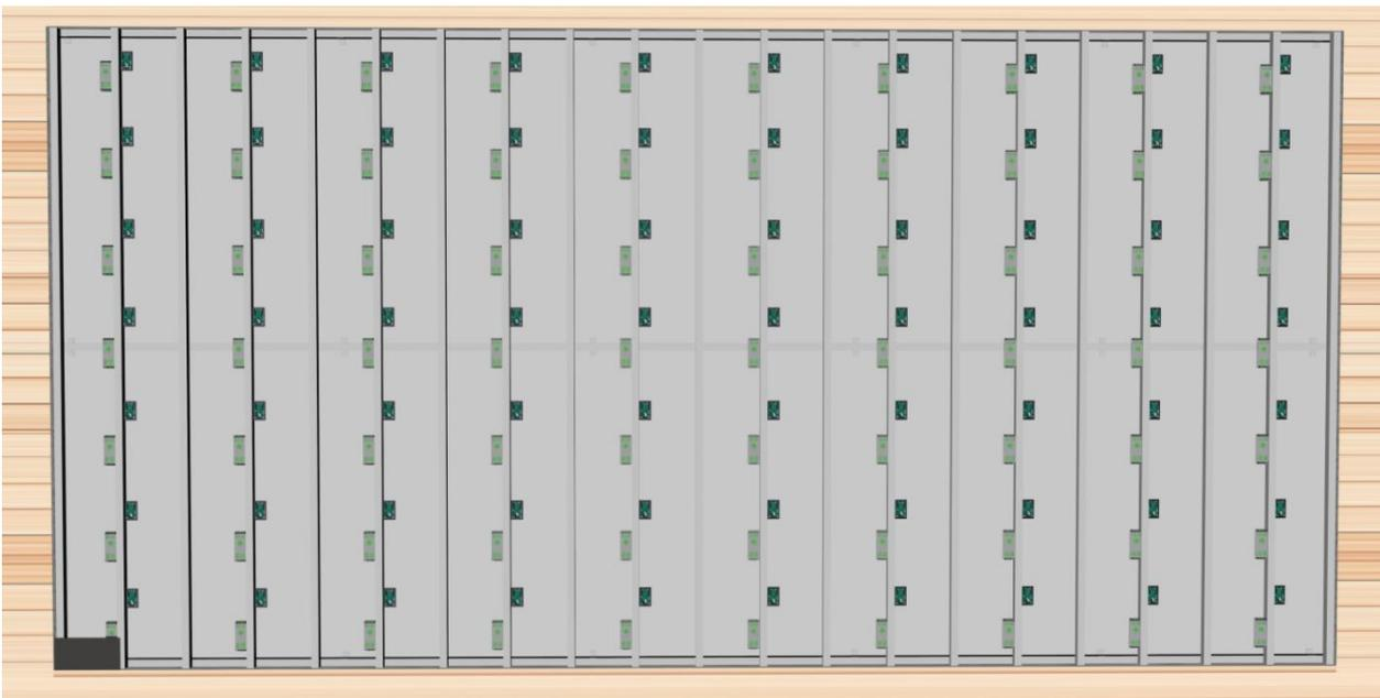
2. 第二块安装在第一块模组右边，安装时同第一块模组需在安装时接入相对应的电源线及接收卡排线，安装时要求与第一张模组在同一平面，若不在需调整平整度。
