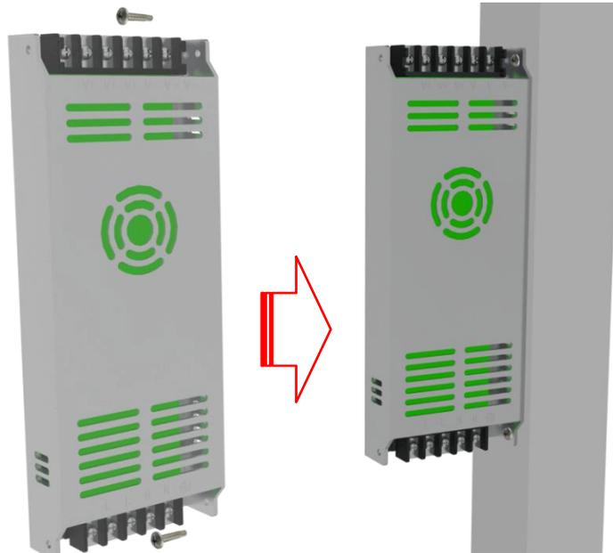
电源固定安装时需安装至所带载区域的居中位置，以便后续安装时接线
