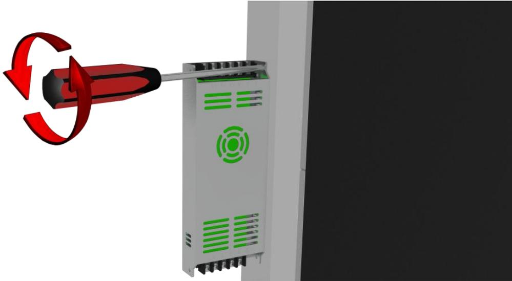
将固定电源的自攻螺丝拧下即可拆卸电源（在拆电源线的过程中，应保持屏体断电）
